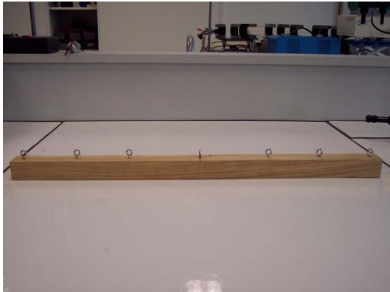
Liteau servant de poutre
